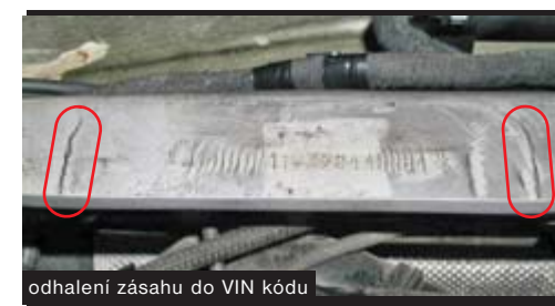
pohled před použitím magneticko-práškové metody
