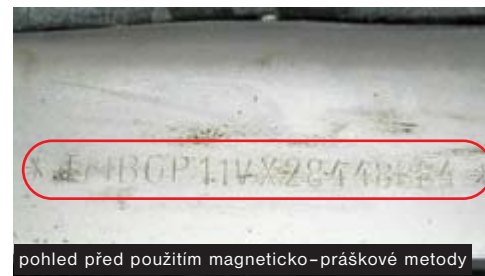
odhalení zásahu do VIN kódu
